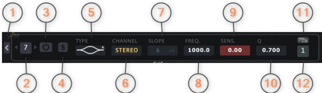
Pre-filter controla a alimentação do sinal no equalizador dinâmico. Você pode retirar partes do espectro (não processadas pelos equalizador dinâmico) ou reforçar (mais processado pelo equalizador dinâmico) A exibição do painel de pré-filtro pode ser alternada com o pequeno ícone logo abaixo.
